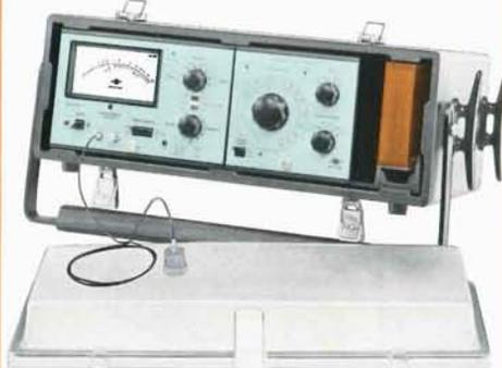
**3513 Analizzatore di vibrazione portatile** è un sistema completamente a sé stante, progettato per semplificare l'analisi di vibrazioni all'aperto. Consiste in un misuratore di vibrazioni 2511 in unione con un filtro passabanda sintonizzabile 1621, entrambi con il loro accessori standard, e riposto in una robusta custodia di materiale plastico, KA 2000. Sono anche inclusi due conduttori d'interconnessione, batterie al NiCd per il 1621 ed un secondo caricabatterie ZG 0113.
