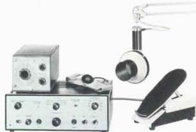
**5524 Sistema per l'analisi stroboscopia della laringe.** Fornisce un'immagine ferma o di lento movimento della laringe sollecitata. Il sincronismo dello stroboscopia avviene per mezzo di un microfono che preleva il suono della voce. Il segnale del microfono viene amplificato e filtrato in modo che il sincronismo sia più sicuro senza armoniche che possono causare falsi sincronismi.
