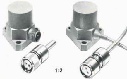
**8308 — 8310.** Accelerometro differenziale particolarmente adatto nel monitoraggio continuo di vibrazioni in macchine industriali e motori di aerei in servizio. La sensibilità a guadagno unifacato (Uni-Gain)® permette la sostituzione diretta. Può essere usato fino a  $400^\circ\text{C}$  e in presenza di forti radiazioni nucleari. Uscita bilanciata. Sono disponibili cavi speciali per l'8308. L'8310 viene fornito con un cavo incorporato da 3 mt. per alte temperature e di notevole resistenza.
