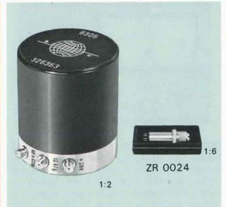
**8306 —** Accelerometro ad alta sensibilità per basse frequenze, e per bassissimi livelli (fino a  $0,00002 \text{ ms}^{-2}$ ). Uscite di carica e di tensione Uni-Gain molto alte. Preamplificatore incorporato con filtro passa-basso. Richiede una alimentazione di  $28 \text{ Volt}/2 \text{ mA}$ .
